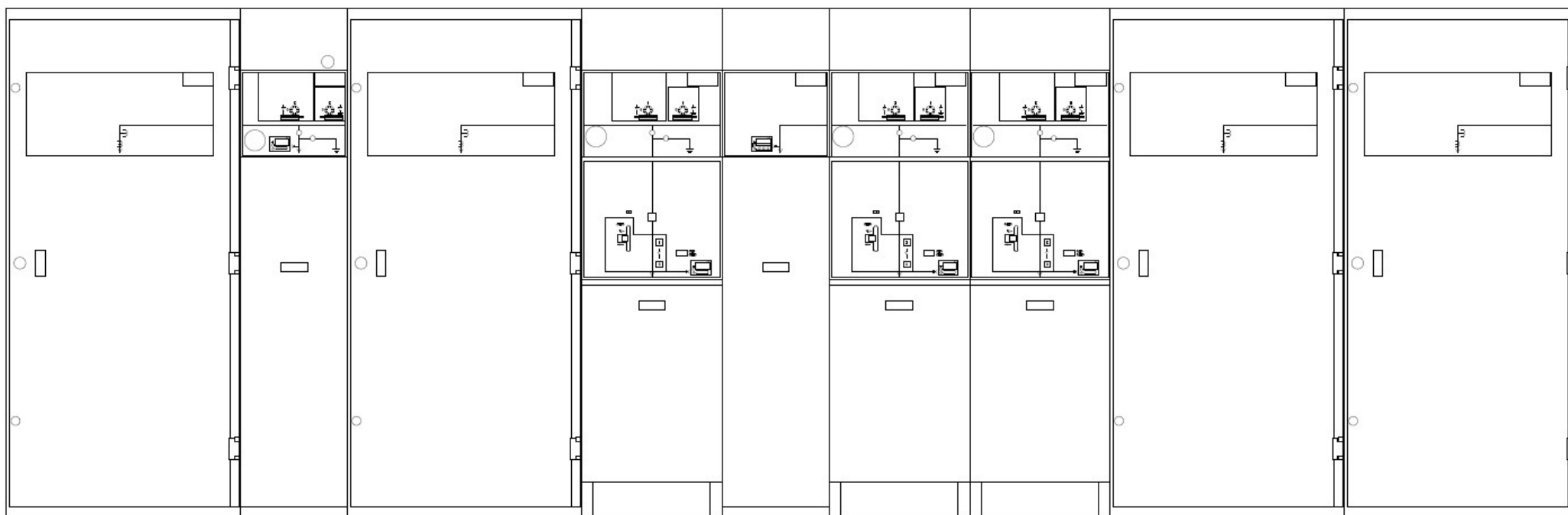
Figura 06 - TIPO 3 - 15 kV - Vista Frontal
