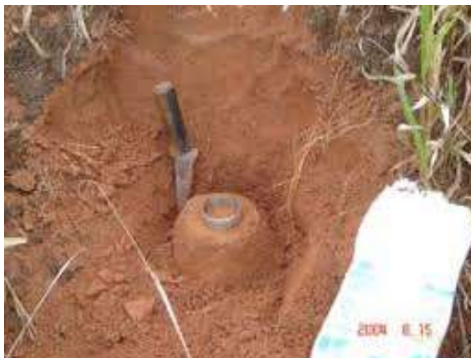
Figura 9 – Coleta de amostra direto nos anéis de ensaio para o Cisalhamento Direto e Adensamento.
