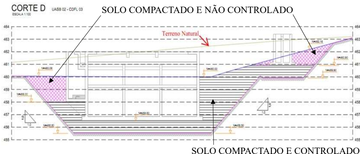
Figura 21 – Definição de volumes de Reaterro Compactado e Controlado e volumes Compactados e Não Controlados.
